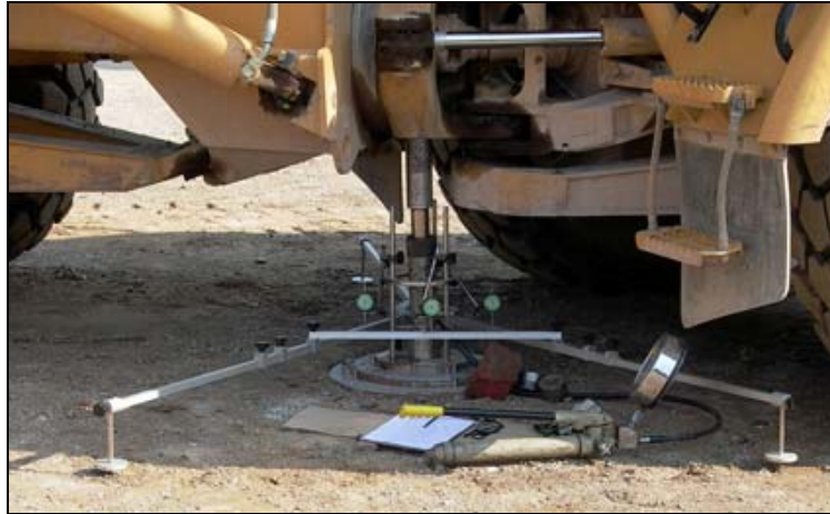
Prova su piastra utile per la stima del coefficiente di sottofondo di Winkler
